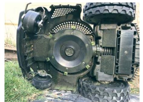
Der Blick auf die Unterseite eines Mähroboters zeigt, dass dort mehrere Messer rotieren und eine Gefahr für Tiere darstellen. Foto: Wouter Hagens / CC BY-SA 4.0
